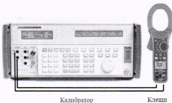
Рисунок 1 – Схема подключений для определения абсолютной основной погрешности измерений напряжения постоянного тока, абсолютной основной погрешности измерений напряжения переменного тока, абсолютной основной погрешности измерений электрического сопротивления постоянному току, абсолютной основной погрешности измерений электрической емкости (положение поворотного переключателя режимов работы клещей показано условно)
